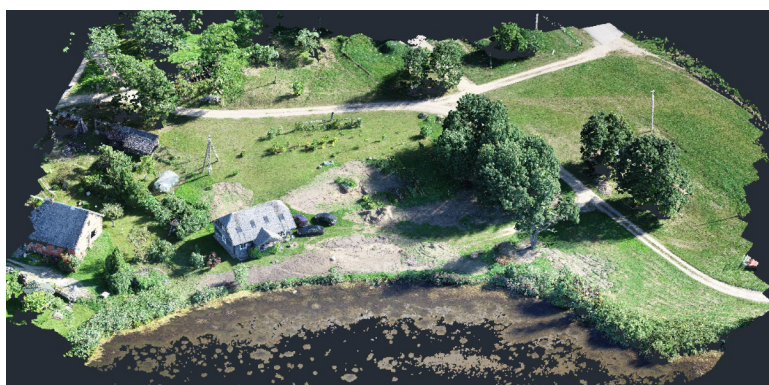
7 paveikslas. Taškų debesis „AutoCAD Geomap 2022“ programos aplinkoje
